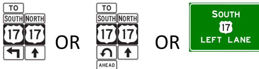
FIGURE 8. RECOMMENDED CONFIRMATORY OR ADVANCE TURN SIGNS MAJOR ROAD IN ADVANCE OF THE U-TURN LANE.
