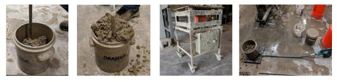
(a) (b) (c) (d) Figure 2.7.2 (a) rodding, (b) internal vibration with stinger vibrator, (c) vibrating table, and (d) MinT.
